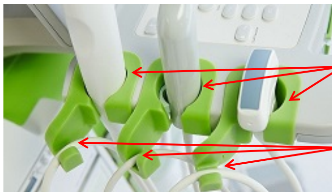
Rys. 36: Uchwyty na przetwornik/ żel i prowadnice kabla
