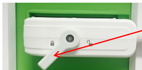
Rys. 28: Orientacja złącza przetwornika
