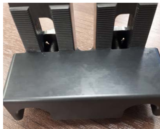
Rys. 38: Wyśrodkowany uchwyt na siatkę szablonową
