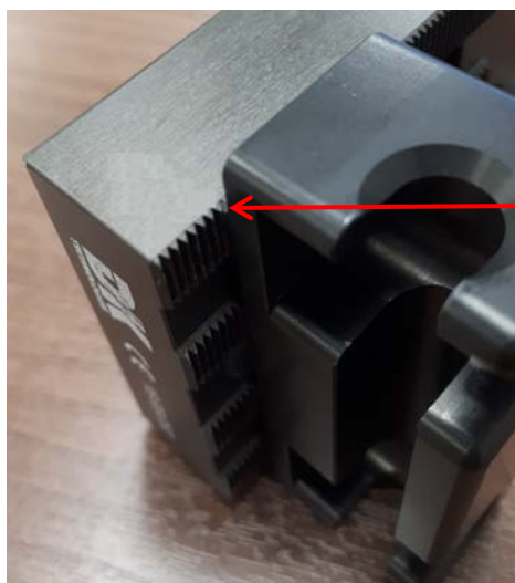
Rys. 37: Uchwyt na siatkę szablonową na pozycji 8. sworznia
