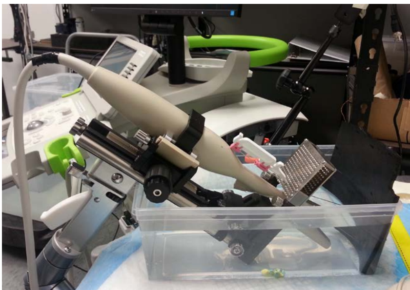
Rys. 41: Przetwornik i stepper przekroczeniowy w kąpielii wodnej
